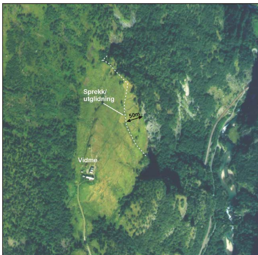
Fig. 21. Utsnitt av flybilde fra Vidme som viser lokalisering av en åpen sprekk som trolig er i bevegelse.
