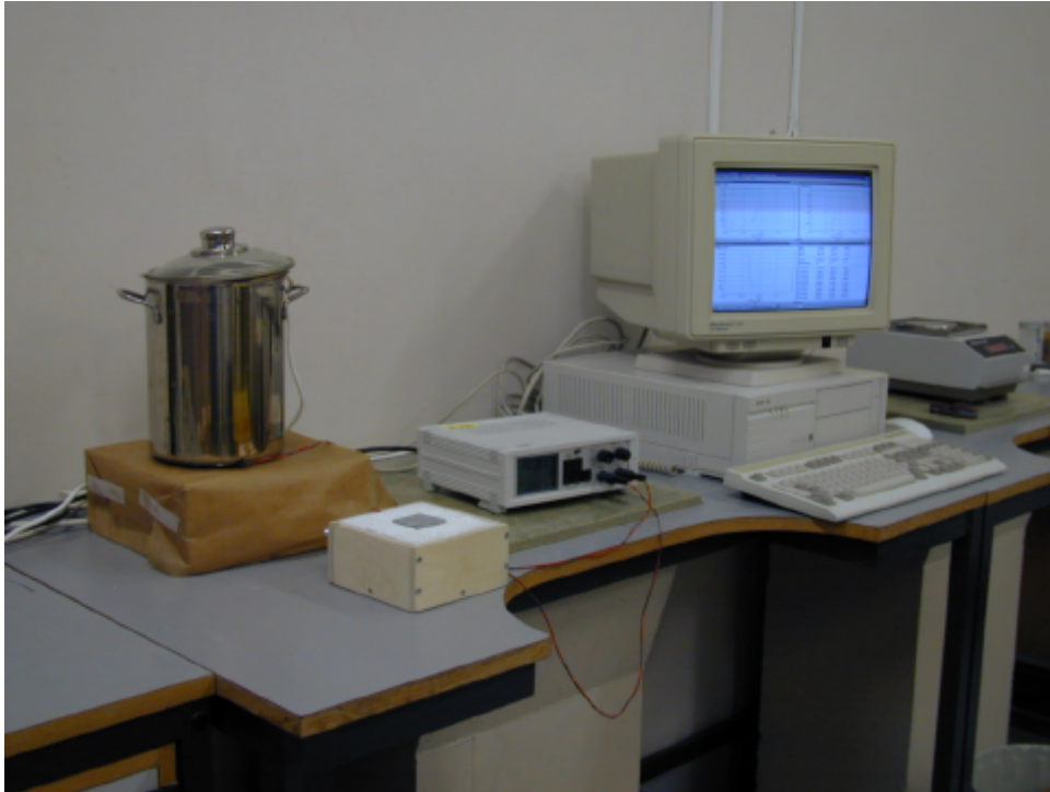
Figur 1 NGUs utstyr for måling av varmeledningsevne.
