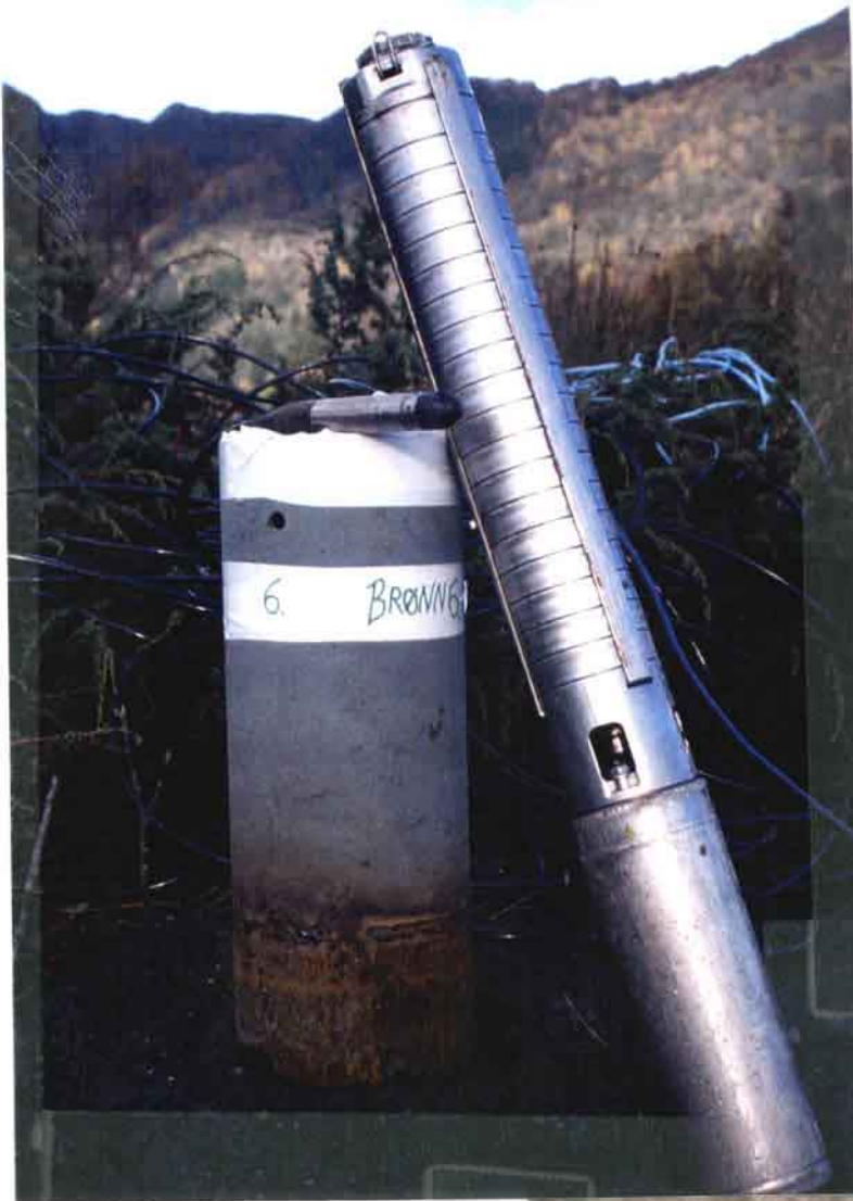
Figur 3.1. Senkepumpe (4'') og elektronisk vannstandssensor ved siden av brønn 6.
