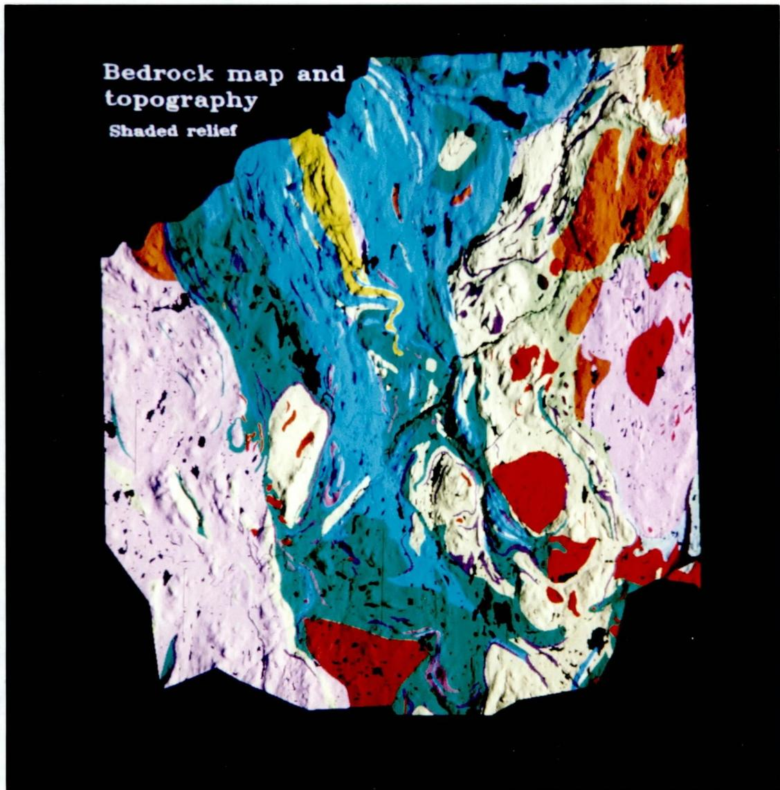
Fig. 2. Kombinert berggrunnskart og topografisk relieff-kart ('belysning' fra øst) framstilt ved hjelp av Erdas og Arc/Info. For tegnforklaring: se Kart 1.
