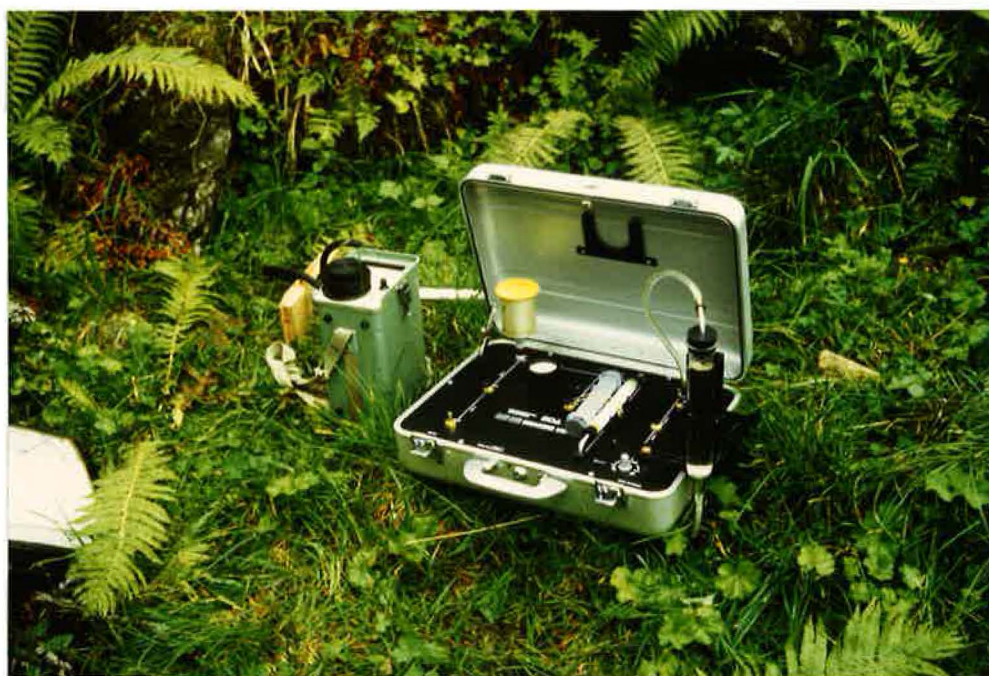
Fig. 1: Bildet viser hele måleapparaturen oppstilt, ferdig til bruk. Vannmåleeeenhten, som ble brukt for første gang på dette oppdraget, består av metallkofferten på bildet samt ei pumpe for å lage undertrykk. Elektronikkenehten er den grønne boksen til venstre for kofferten. Metallsylinderen med gul topp til venstre i kofferten har et ZnS-belegg med den egenskap at det "kondenserer" \alpha -strålingen fra radongassen. Disse sylindrene er av lignende type som for måling av jordluft, men med den forskjell at disse har en lukkemekanisme slik at de automatisk stenges når de tas av panelet på kofferten.
