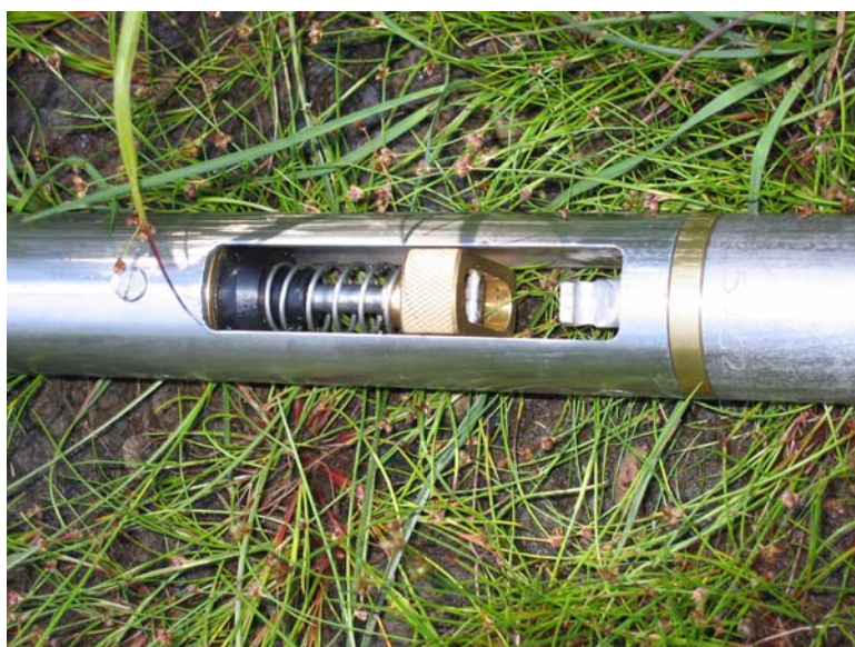
Lukkemekanisme. Prøvetakeren holdes åpen ved å spenne opp en fjær. Når låsemekanismen roterer, slipper den fjærbelastede stangen taket, og prøvetakeren lukkes i topp og bunn.
