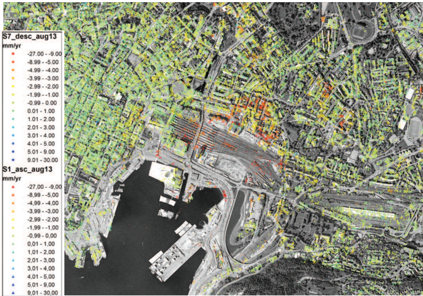
Figur 5.3 InSAR-kart basert på Radarsat-2 viser hastighet av nedsynking ved Oslo S og Bjørvika. Røde sirkler viser nedsynking på opptil 27 mm per år. (NGU)
