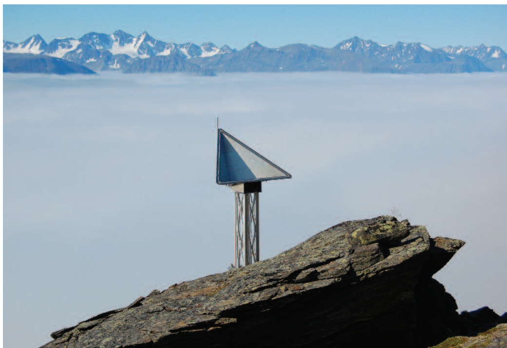
Figur 3.5. Fastmontert reflektor (0,8 m) ved Nordnesfjellet i Troms. Reflektoren er montert på en mast direkte boret ned i fjellet og er en naturlig spredde av signal. For å unngå ansamling av snø er reflektoren dekket av pleksiglass. (Harald Øverli Eriksen)
