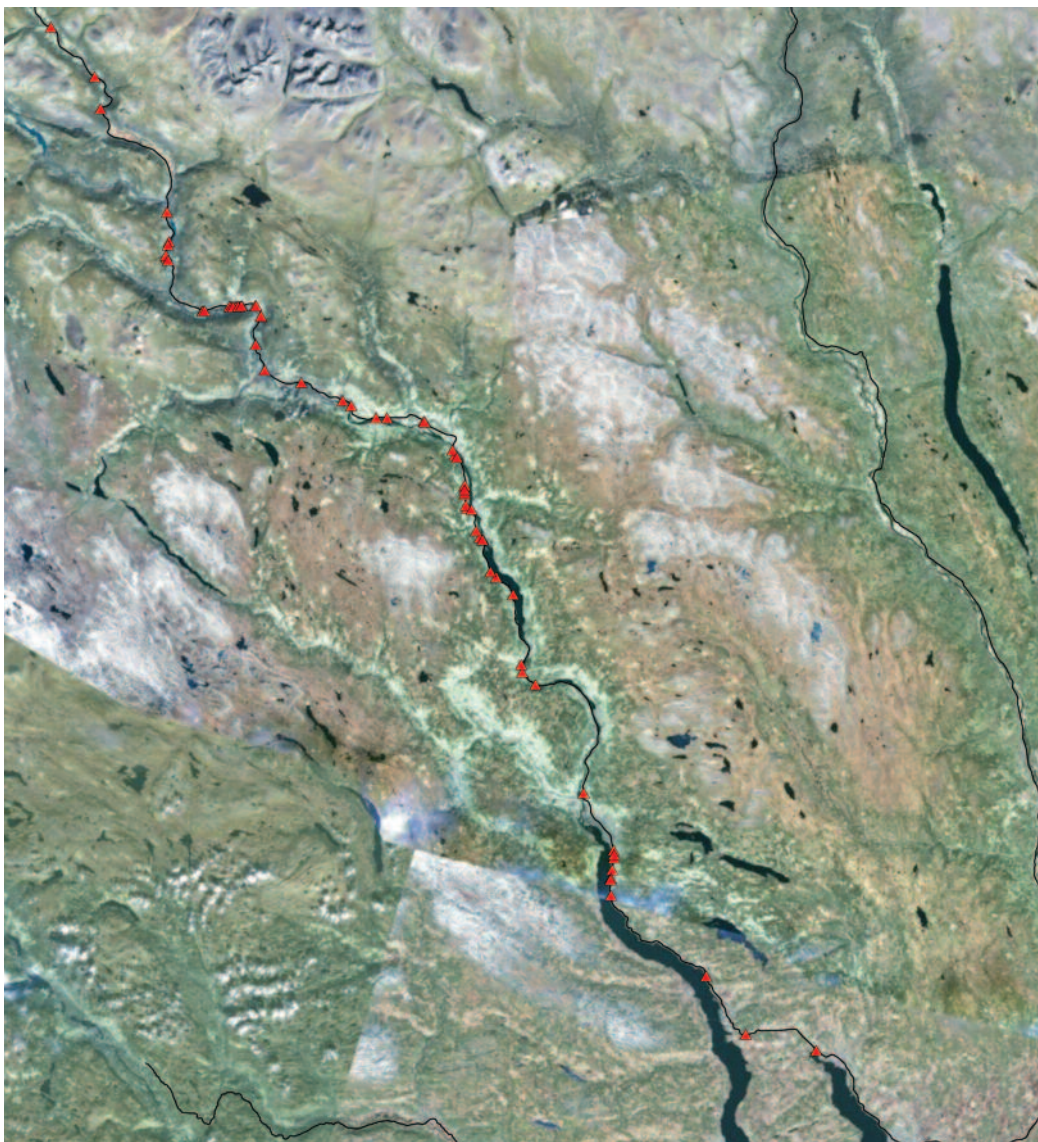
Figur 6.5 Kart som viser skadepunkt på Dovrebanen etter flom og skred i mai 2013. Røde trekanter er skader som førte til stans i trafikken. (Jernbaneverket)
