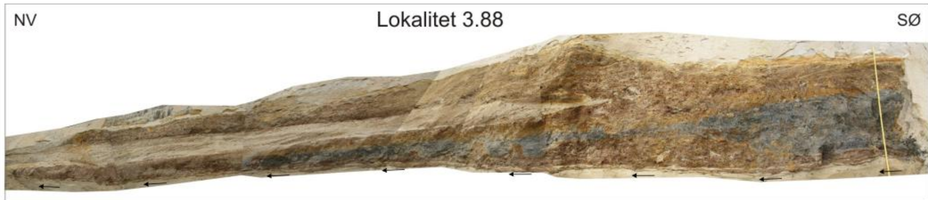
Figur 4.35: Lengden av fotomosaikk er 11 m fra NV til SØ i profilet. Sorte piler indikerer den undre grensen til enhet F.
