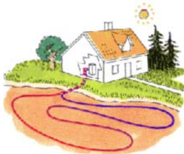
Figur 12. Prinsippskisse av jordvarmeanlegg (Normann Energiteknikk, 2002).
