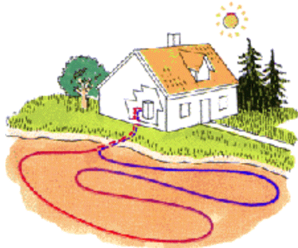
Figur 12. Prinsippskisse av jordvarmeanlegg (Normann Energiteknikk, 2002).
