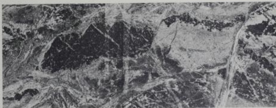
Fig. 10. Polert flate av brekksjert serpentin med slirer av kromitt. Kromitt: Svart - Serpentin: Grått - Magnesitt: Hvitt.
