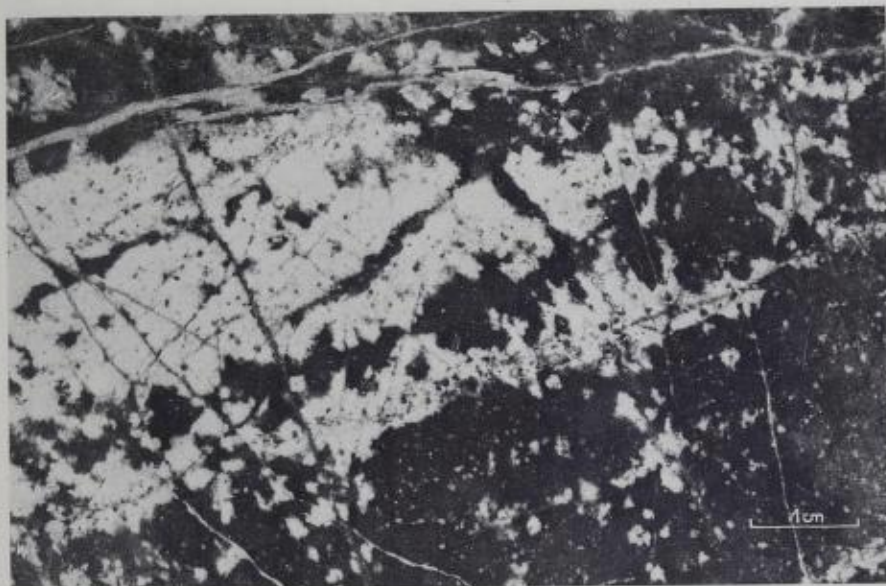
Fig. 8. Polert plate av brekksjert serpentin fra Slipsteinsberget. Mørk grå: Serpentin - Hvit: Magnesitt.
