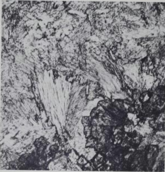
Fig. 5: Mikrofotografi av råtalk, 60 x, kryssete nicols. Talk: Lys grå — Magnesitt: Mørk grå (nederst til høyre).
