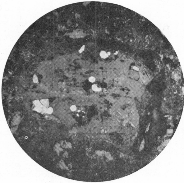
Fig. 4. Mikrofoto av polerslip som viser runde legemer av kamacitt (hvit) med diameter 0,01 mm som ligger inne i et olivinkorn (130 x). Photomicrograph showing spherules of kamacite, white, diameter 0,01 mm, in olivine (130 x).
