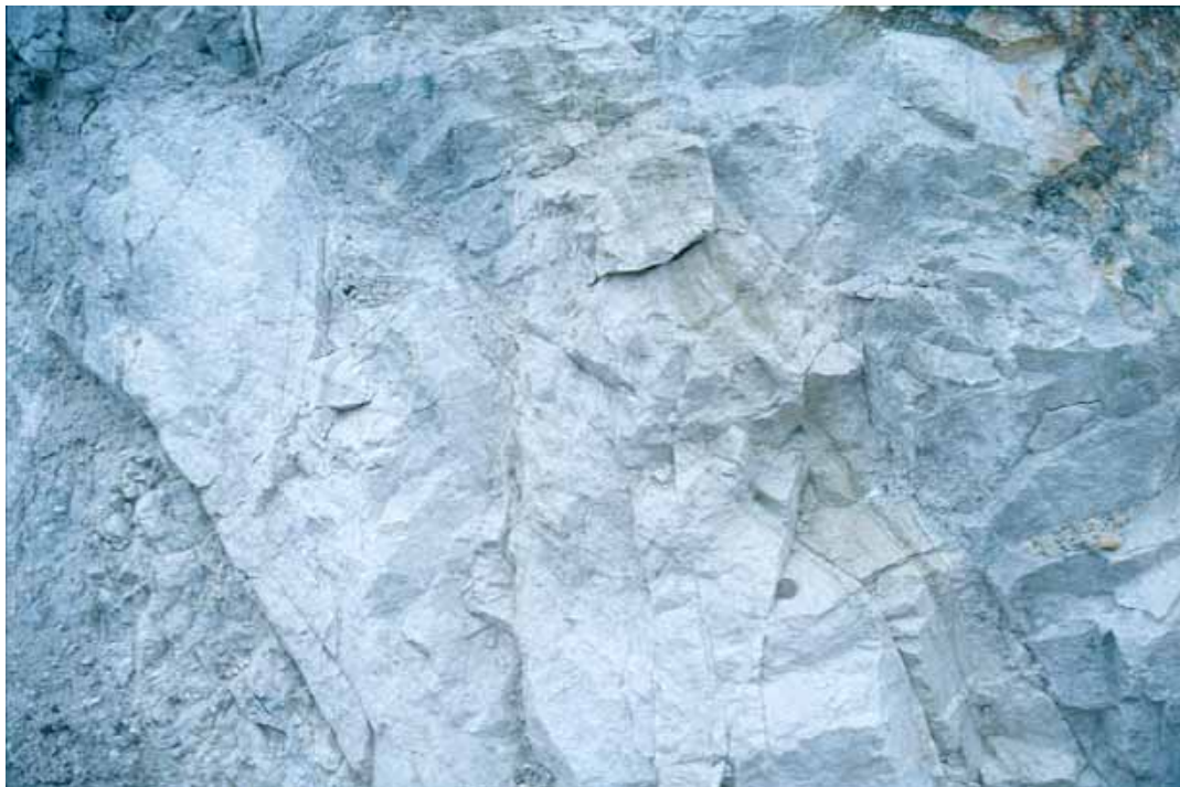
Fig. 3. Fullstendig omdannet kritthvit anortositt, som er ettertraktet på grunn av sitt potensial for f.eks. fyllstoff og keramisk råstoff. Veiprofil mellom Hellvik og Eike.
