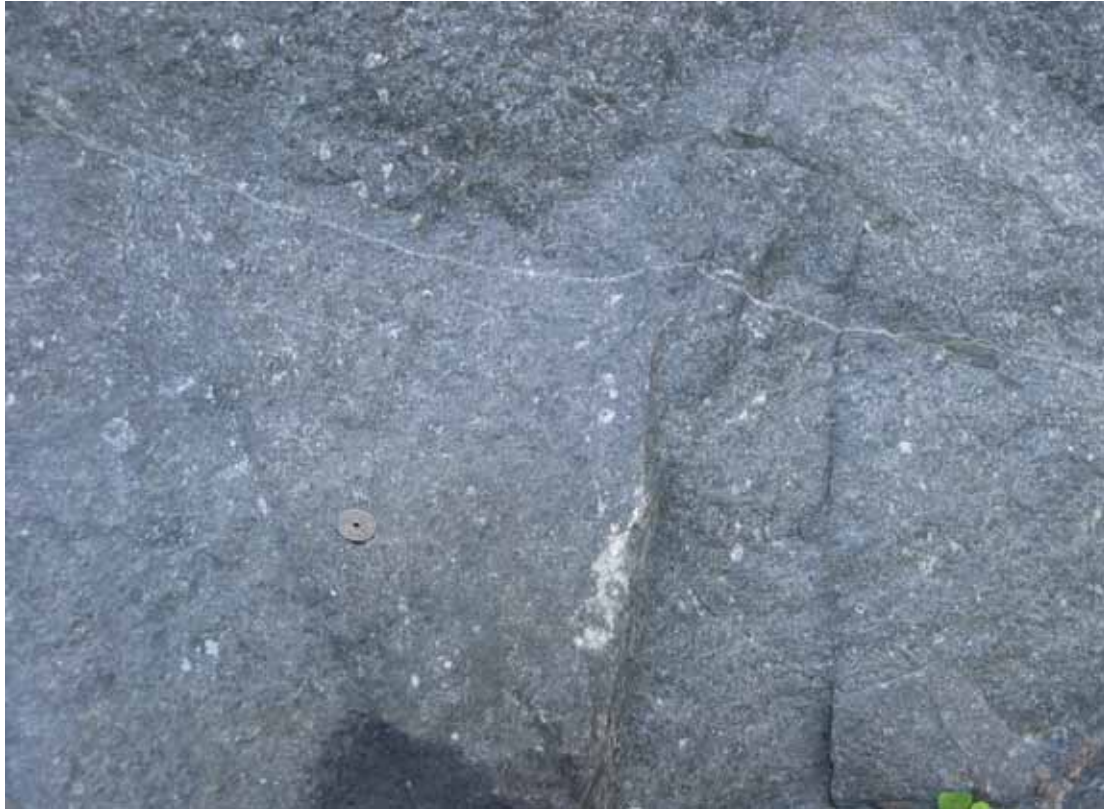
Fig. 3. Finkornet omdannet lavabergart velegnet for pukk på grunn av sin mineralsammensetning og finkornethet. Den ble i 2005 prøvetatt for mekanisk analyse. Nordlige Ropeid-halvøya.
