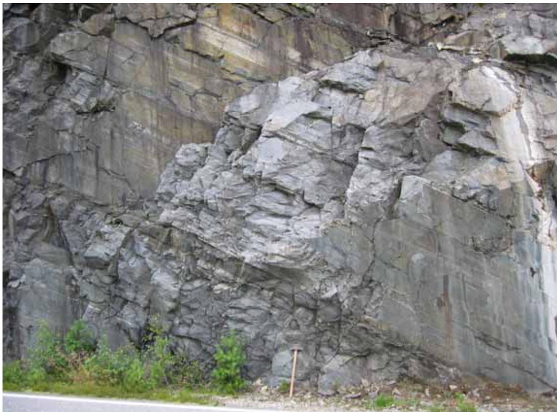
Fig. 4. Mylonittisk omdannet vulkanitt. Mylonitten antas å ha god kvalitet for pukk på grunn av gunstig mineralsammensetning og liten kornstørrelse. Denne lokaliteten ble i 2005 prøvetatt for mekanisk analyse. Nordlige Ropeid-halvøya.
