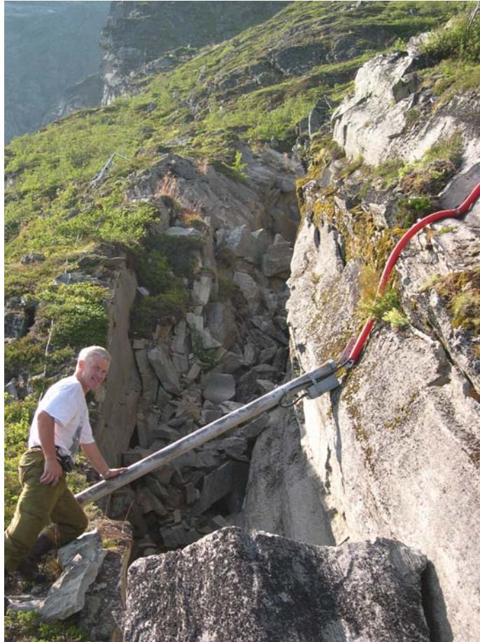
Figur 2. Åkernesremna med ekstensiometer som måler bevegelse i sprekk.
