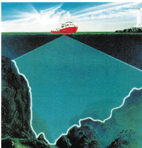
Kartlegging av dybdeforhold med multistråle ekkolodd (Ill. SIMRAD)
