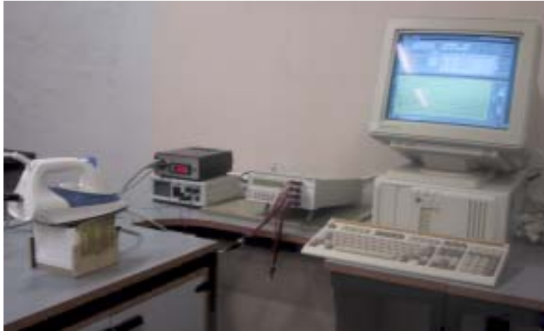
Figur 25: Apparatur for måling av varmeledningsevne.
